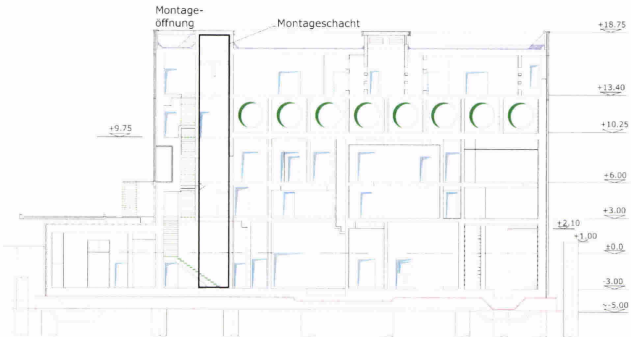
Abb. 2: Querschnitt des UNS-Gebäudes mit Montageschacht (markiert)
