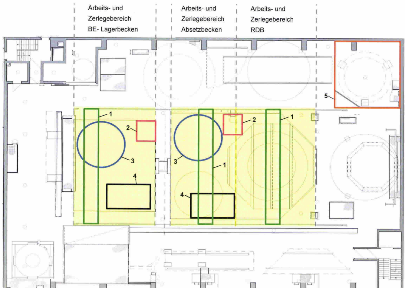
Abbildung 5: Übersicht Beckenflur, Beispiel einer möglichen Anordnung der Arbeits- und Zerlegebereiche für den Abbau der RDB- Einbauten
